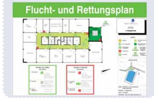
Erstellen Sie mit dem TRICAD MS® Brandschutzlayout Flucht- und Rettungspläne mit Brandschutzsymbolen samt Hilfslinien und Beschriftung inklusive der Planung von Richtungspfeilen, Bereichskennzeichnungen und Randmarkierungen.
