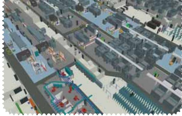
Mit dem Modul Einrichtungslayout verfügen Sie über das ideale Werkzeug für die einfache und schnelle Platzierung von Bauteilen über die gesamte Fabrik hinweg. Integrieren Sie unkompliziert neue und vorhandene MicroStation-Bauteile sowie solche aus AutoCAD® und hinterlegen Sie analog den Fachapplikationen bei diesen Elementen ergänzend die TRICAD MS® Intelligenz.
